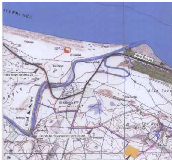
*Figure 4 : Carte montrant la conduite d'évacuation des effluents de la station de traitement des eaux usées vers l'Oued Moulouya, ce qui va polluer ce Sibe*
