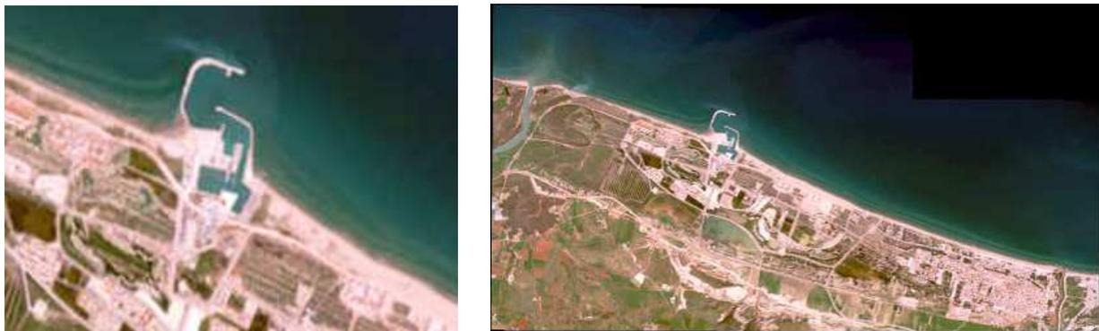
*Figure 3 : Image satellitale du littoral de Saïdia prise en Février 2009 montrant la nouvelle digue de la Marina de plaisance, les perturbations des sédiments au voisinage du port, la formation des barres d'avant côte (premier et second ponts de sable) et le début d'ensablement des deux côtés, Est et Ouest du port.*
